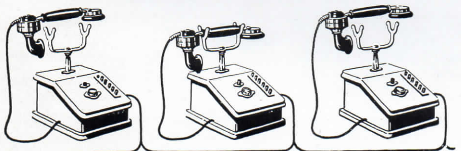
Abb. 3. Teilnehmer 1 hält Rückfrage bei Teilnehmer 3, sämtliche Sperrsignale in „Besetzt“-Stellung.
