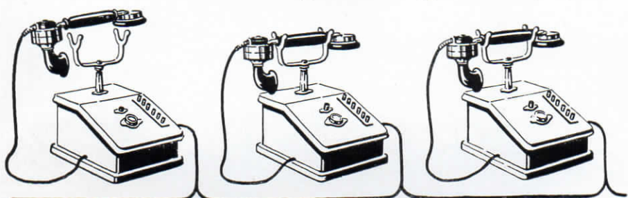
Abb. 2. Teilnehmer 1 auf die Amtsleitung eingeschaltet, an sämtlichen Apparaten Sperrsignale in „Besetzt“-Stellung.
