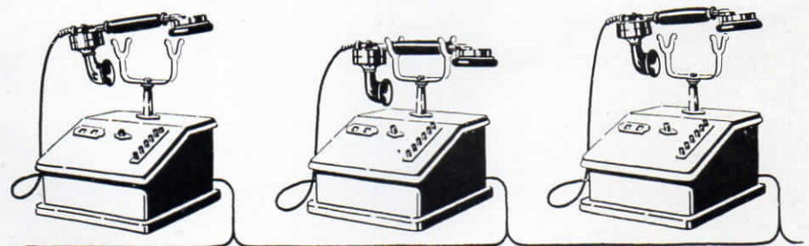
Abb. 7. Teilnehmer 1 hält Rückfrage bei Teilnehmer 3, an sämtlichen Apparaten beide Sperrsignale in „Besetzt“-Stellung.
