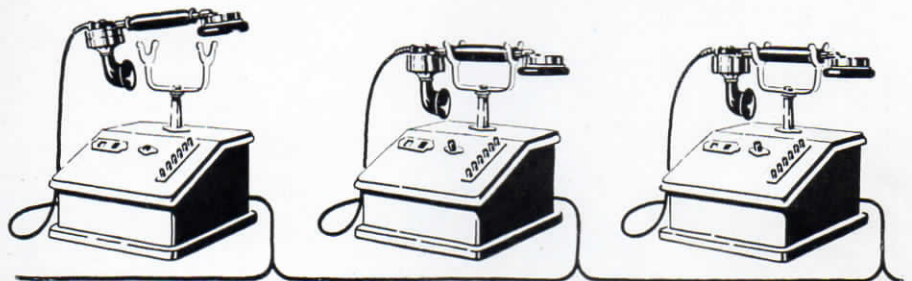
Abb. 6. Teilnehmer 1 auf die Amtsleitung eingeschaltet, an sämtlichen Apparaten linkes Sperrsignal in „Besetzt“-Stellung, rechtes Sperrsignal in Ruhelage.
