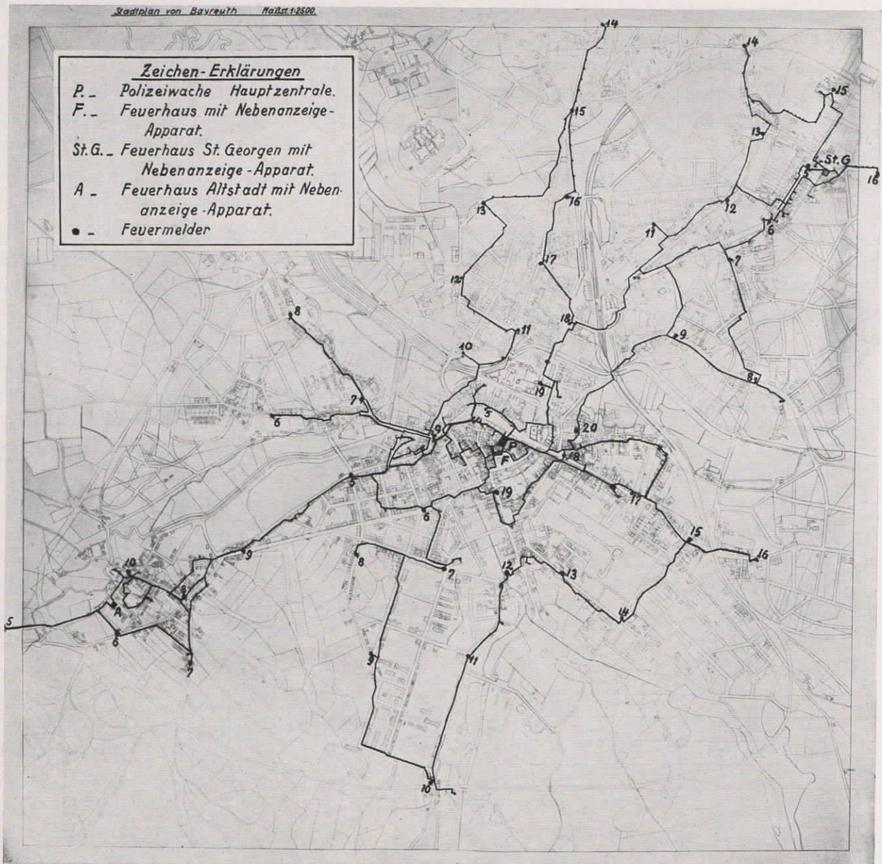
Abb. 3. Stadtplan mit den eingezeichneten Schleifenleitungen der kombinierten Feuermelde-Alarm-Telephon- und Uhren-Anlage der Stadt Bayreuth.
