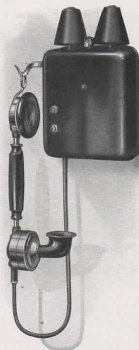
Abb. 11. Alarmwecker mit Fernsprecheinrichtung für die Führer der Feuerwehr.
