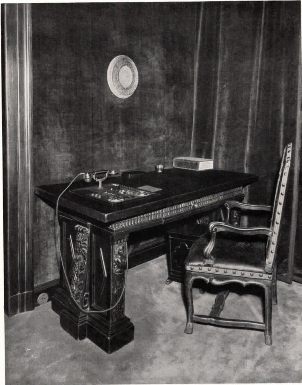
Abb. 8. Ecke im Ankleidezimmer. Die gesamte fernmeldetechnische Apparatur ist in einen Schreibtisch eingebaut.
