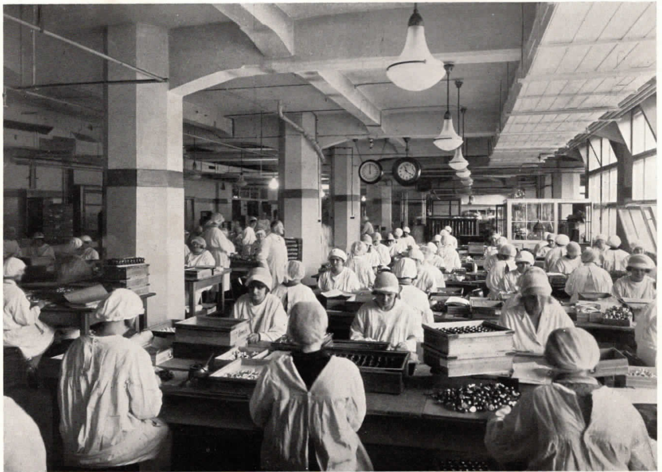
Abb. 4. Fabriksaal mit doppelseitiger Normalzeit-Nebenuhr, Personenruf-Einrichtung nach dem Zeigersystem sowie Fuld-Fernsprechapparat in der Sarotti A.-G., Berlin.
