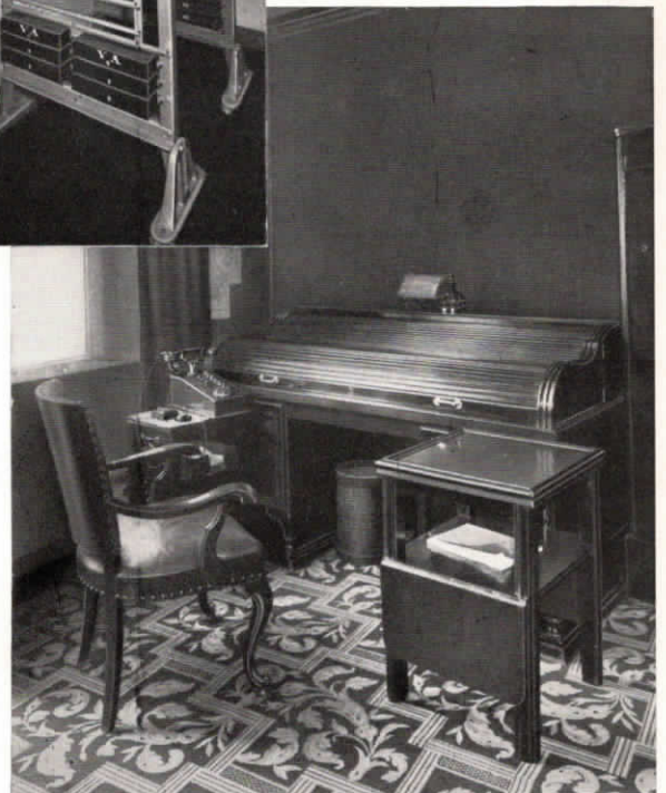
Abb. 62. Vollautomatische Fuld-Hauszentrale für 100 Teilnehmer nebst Prüf-schrank und Rangierverteiler.
