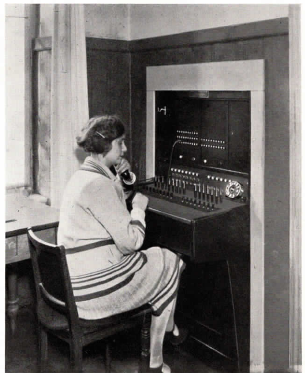
Abb. 52. Der Vobach-Verlag in Berlin, Dessauer Straße, besitzt eine Fuld-Fernsprech-Glühlampnenzentrale für acht Amtsleitungen und fünfzig Nebenstellen, ferner einen Hausautomaten für 80 Teilnehmer.
