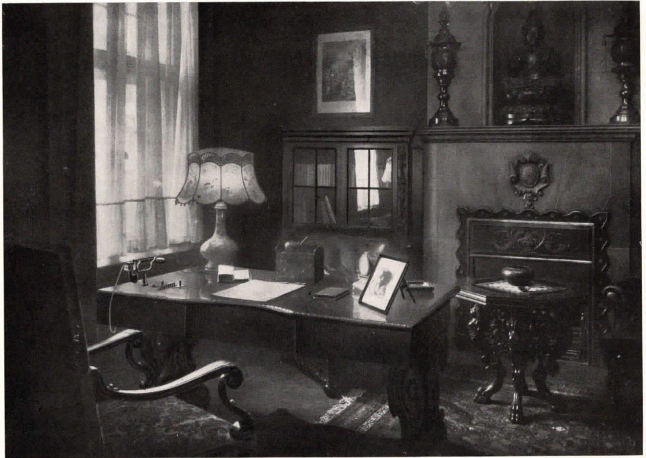
Abb. 82. In einen Schreibtisch eingebaute Fernsprecheinrichtung in einem Berliner Wohnhaus.
