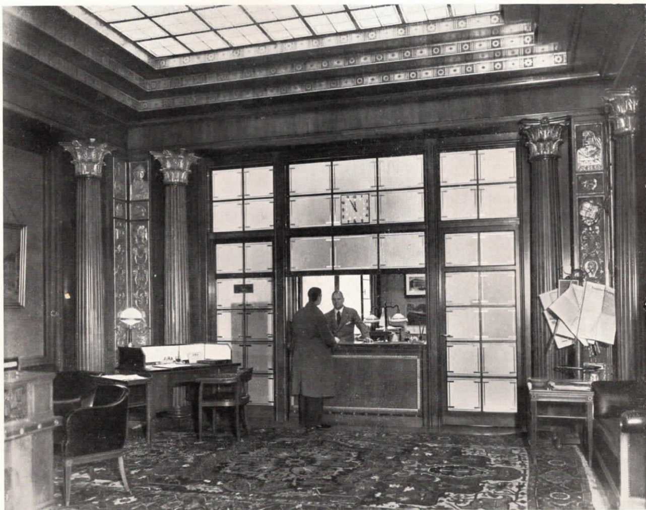
Abb. 5. Elektrische Normalzeit-Nebenuhr mit Glas-Zifferblatt in der Akkreditiv-Abteilung der Dresdner Bank in Berlin.
