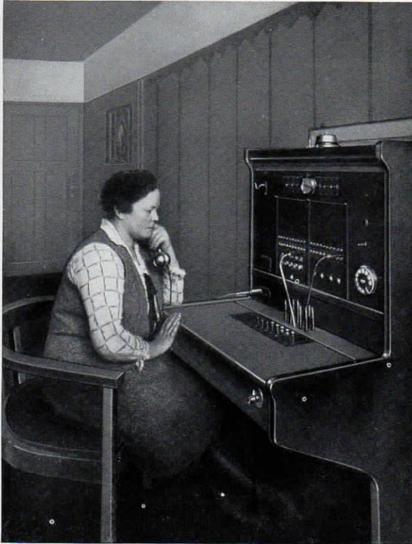
Abb. 8: Fuld-Glühlampenzentrale für 4 Amtsleitungen und 40 Nebenstellen, sowie einer Querverbindung nach Gleiwitz in der Preußischen Bergwerks- und Hütten A. G. Gußstahlwerk Malapane
