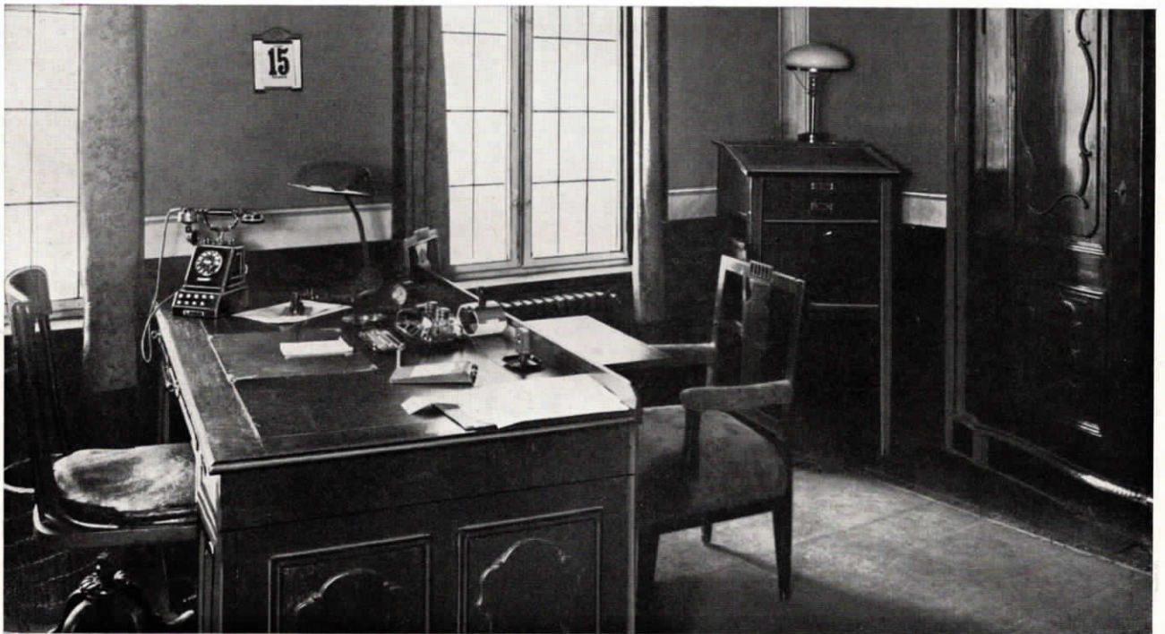
Abb. 16. „Fuld“-Fernsprechapparat in einem Geschäftsführerzimmer der Vereinigung Breslauer Arbeitgeber-Verbände in Breslau. Der Apparat ist mit 4 Tasten versehen: Die Taste 1 stellt die direkte Verbindung mit dem Amt her, die Taste 2 die Verbindung mit der halbautomatischen Abfragezentrale, die Taste 3 die Verbindung mit der Automatenzentrale (nach Wahl der entsprechenden Hausnummer direkte Verbindung mit dem gewünschten Teilnehmer), die Taste 4 schaltet auf den automatischen Mithörschrank und korrespondiert mit den im Sockel befindlichen 9 Lampen; durch Niederdrücken dieser Mithörtaste und Wahl der Amtsleitungen, deren Lampe aufleuchtet (also beispielsweise auf der 5. Amtsleitung durch Wahl der Ziffer 5), kann das betreffende Gespräch mitgehört und mitgeführt werden.
