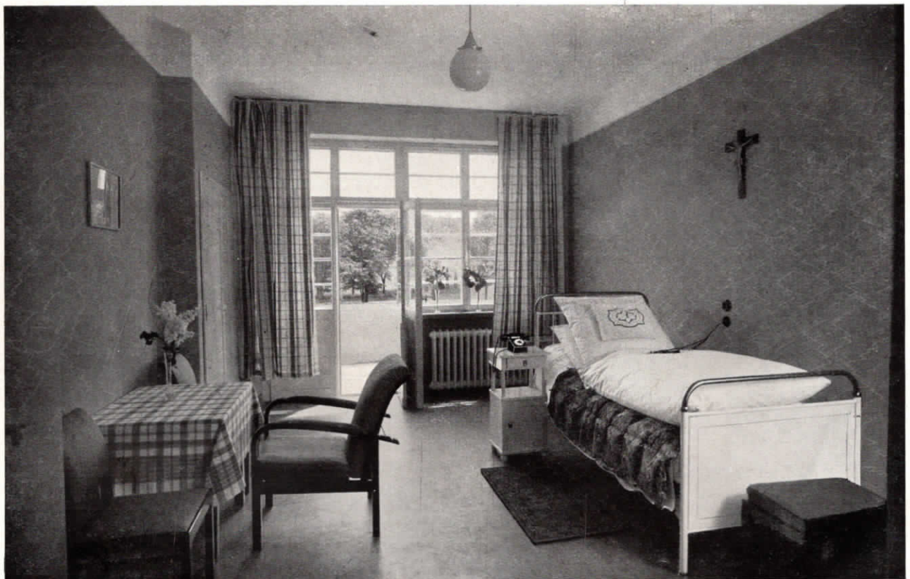
Abb. 3. Krankenzimmer mit Fuld-Fernsprechapparat sowie Birntaster zum Herbeirufen der Schwester mittels der geräuschlosen Lichtrufanlage im Krankenhaus der Barmherzigen Brüder zu Regensburg (Männerbau).
