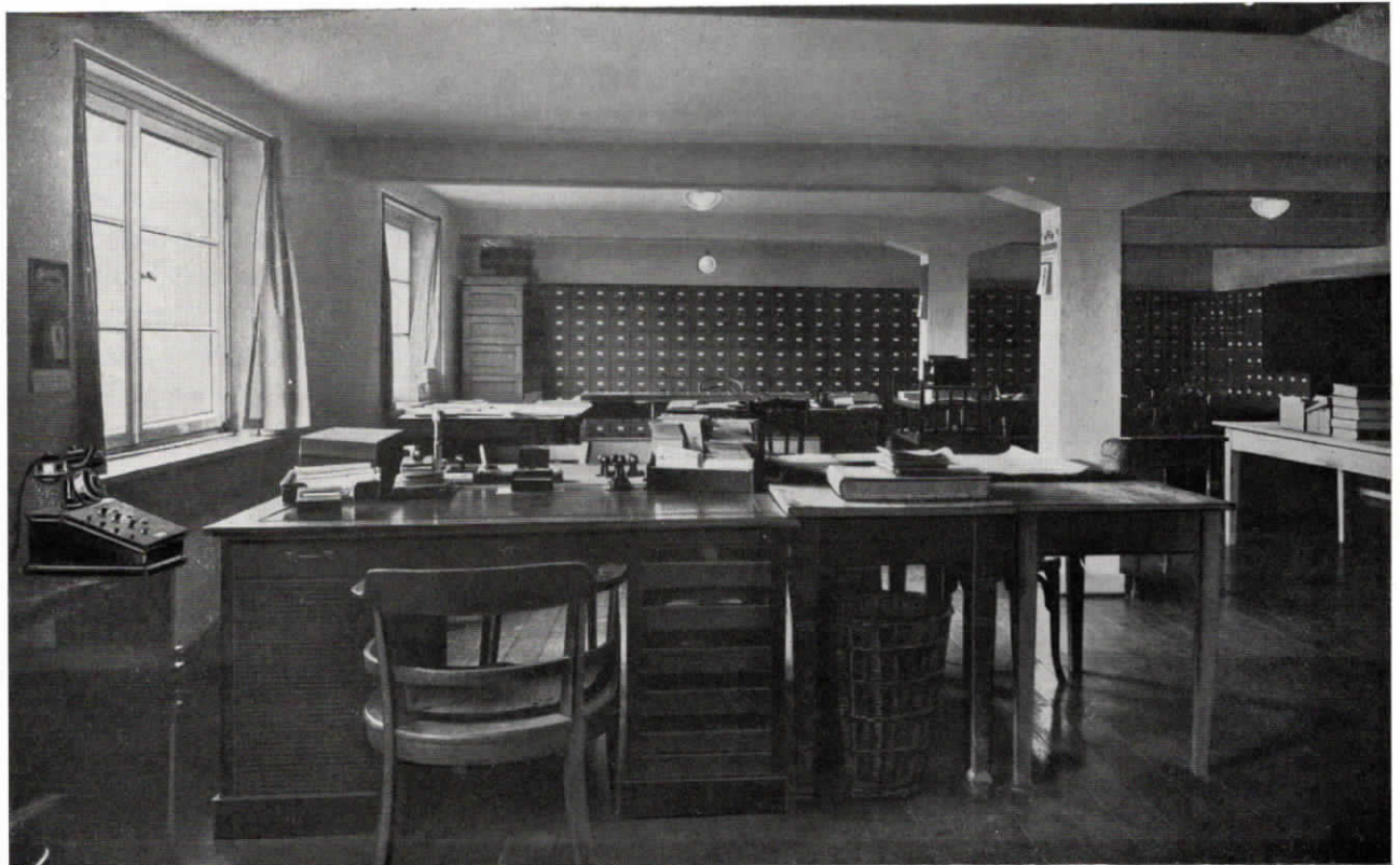
Abb. 93. Ein Büro mit Fuld-Fernsprech-Reihenapparat im Westdeutschen Spielverband in Duisburg. Die Anlage besteht aus 7 Reihenapparaten für 3 Amtsleitungen, einem Verbindungsschrank für 3 außenliegende Nebenstellen und einer automatischen Zentrale für 10 Teilnehmer für den internen Verkehr.
