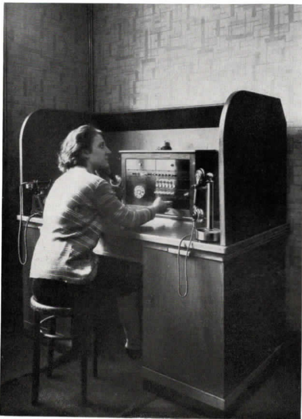
Abb. 33. Die „Spona“ Sportzeitungs- und Nachrichten-Vermittlungsdienst G. m. b. H., Düsseldorf, besitzt eine Fuld-Glühlampenzentrale (Spezialausführung), einen Vorschaltapparat und 6 Nebenstellenapparate.
