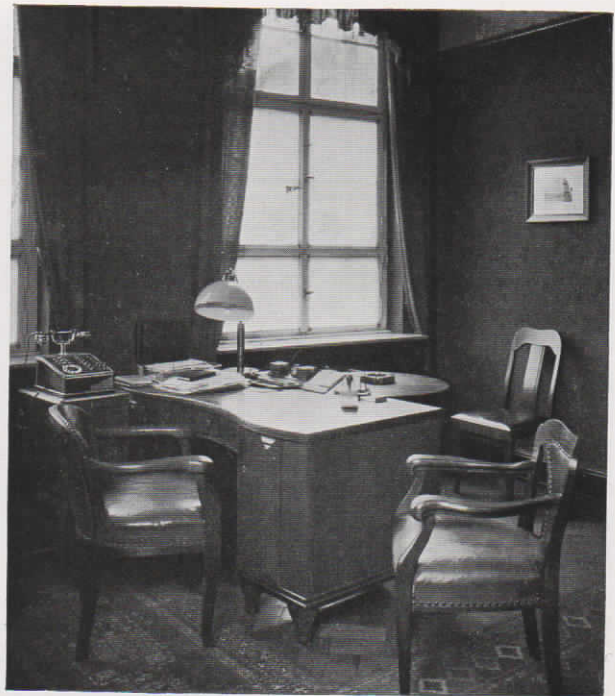
Abb. 43. Direktionszimmer der Katz & Michel Textil A.-G. in Bielefeld mit Fuld-Spezial-Fernsprechapparat. Die Fernsprechanlage besteht aus einer Glühlampen-Nebenstellenzentrale und einer vollautomatischen Hauszentrale. Angeschlossen sind ca. 70 Apparate
