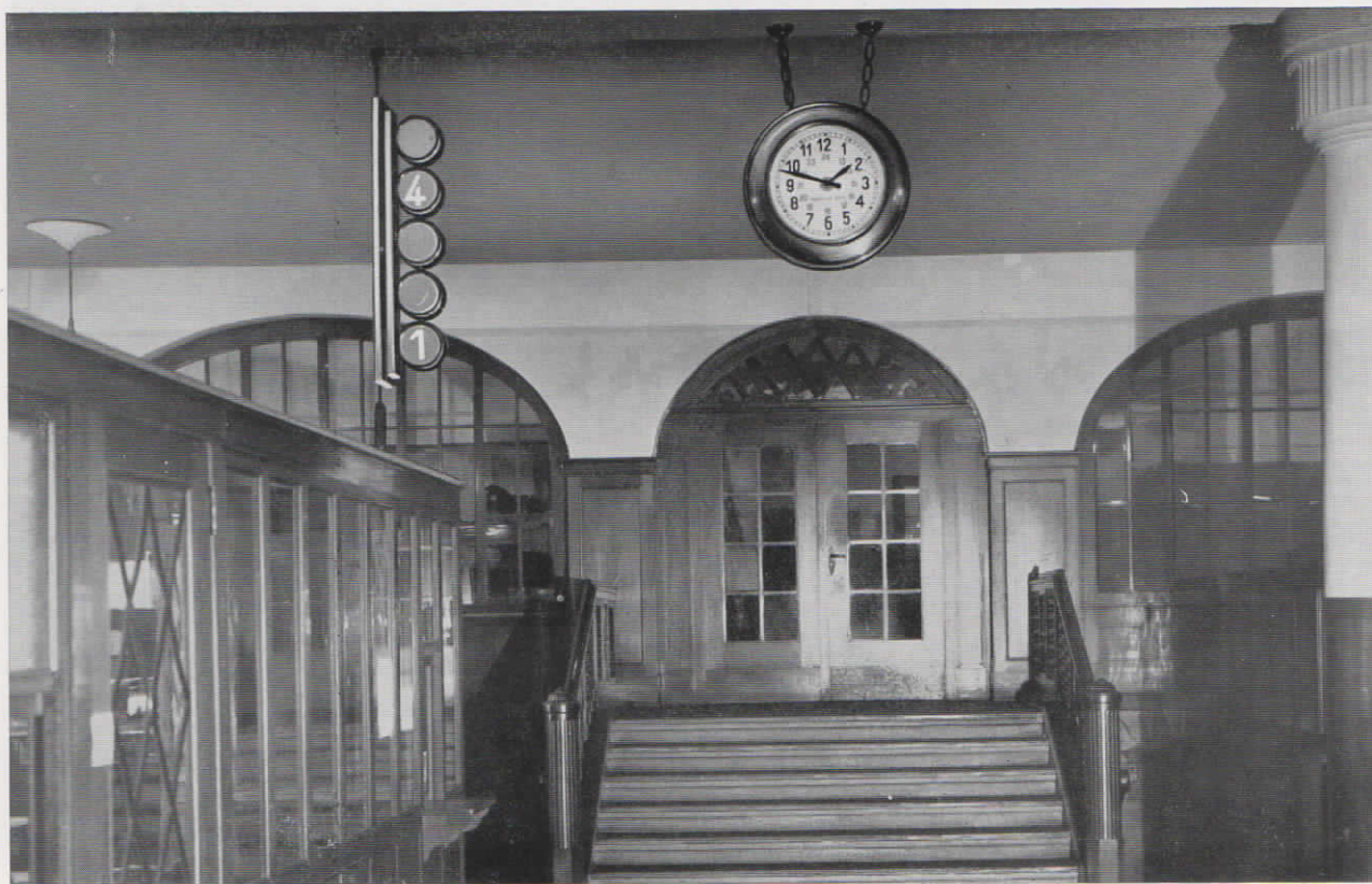
Abb. 4. Fuld-Lichtsignaltaflo für 5 Personen und doppelseitige Normalzeit-Nebenuhr im Hauptbüro der Unionbrauerei A.-G. in Dortmund
