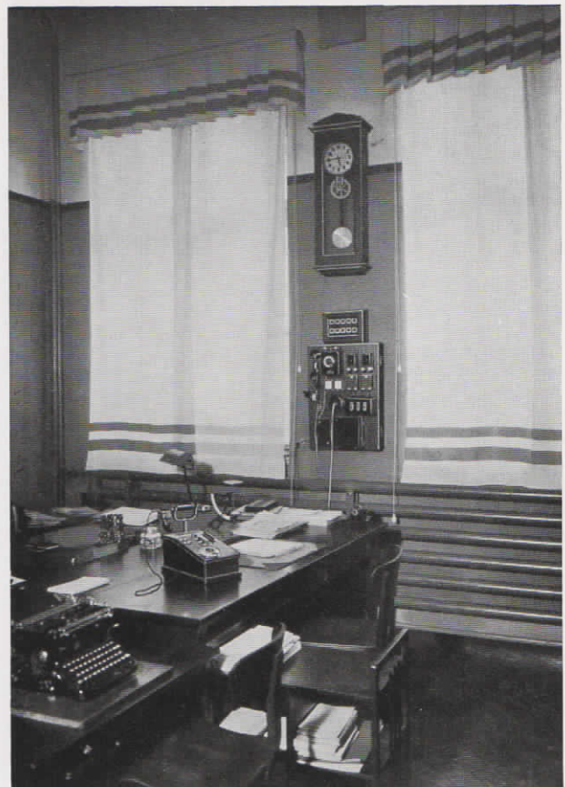
Abb. 8. Arbeitszimmer in der Westfälischen Verwaltungsakademie Bochum mit Fuld-Reihentischapparat und Normalzeit-Signal-Hauptuhr. Unter der Uhr 10 teiliges Fallklappentablo, darunter Kontrollapparat, Umschalter und Signalwecker auf aufklappbarem Holzbrett montiert
