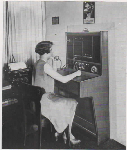
Abb. 32. Bedienungsschrank der halbautomatischen Fuld-Nebenstellen-Zentrale für 4 Amtsleitungen und 15 Nebenstellen beim Deutschen Benzol-Vertrieb der Fried. Krupp A.-G. in Essen. Dem Untereinanderverkehr dient eine vollautomatische Fuld-Hauszentrale
