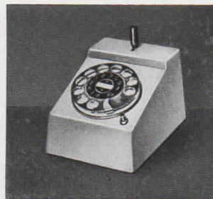
Abb. 6. Einschaltvorrichtung mit Wählscheibe zum Einstellen elektrischer Liederanzeiger in Kirchen
