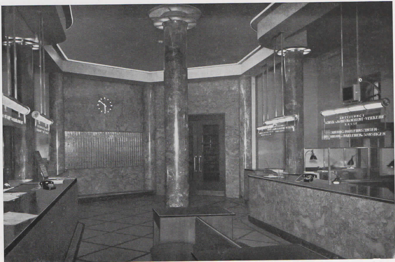
Abb. 17. Schalterraum der Sparkasse des Landkreises Dortmund mit Fuld-Fernsprechapparaten und in die Wand eingelassener Normalzeit-Nebenuhr
