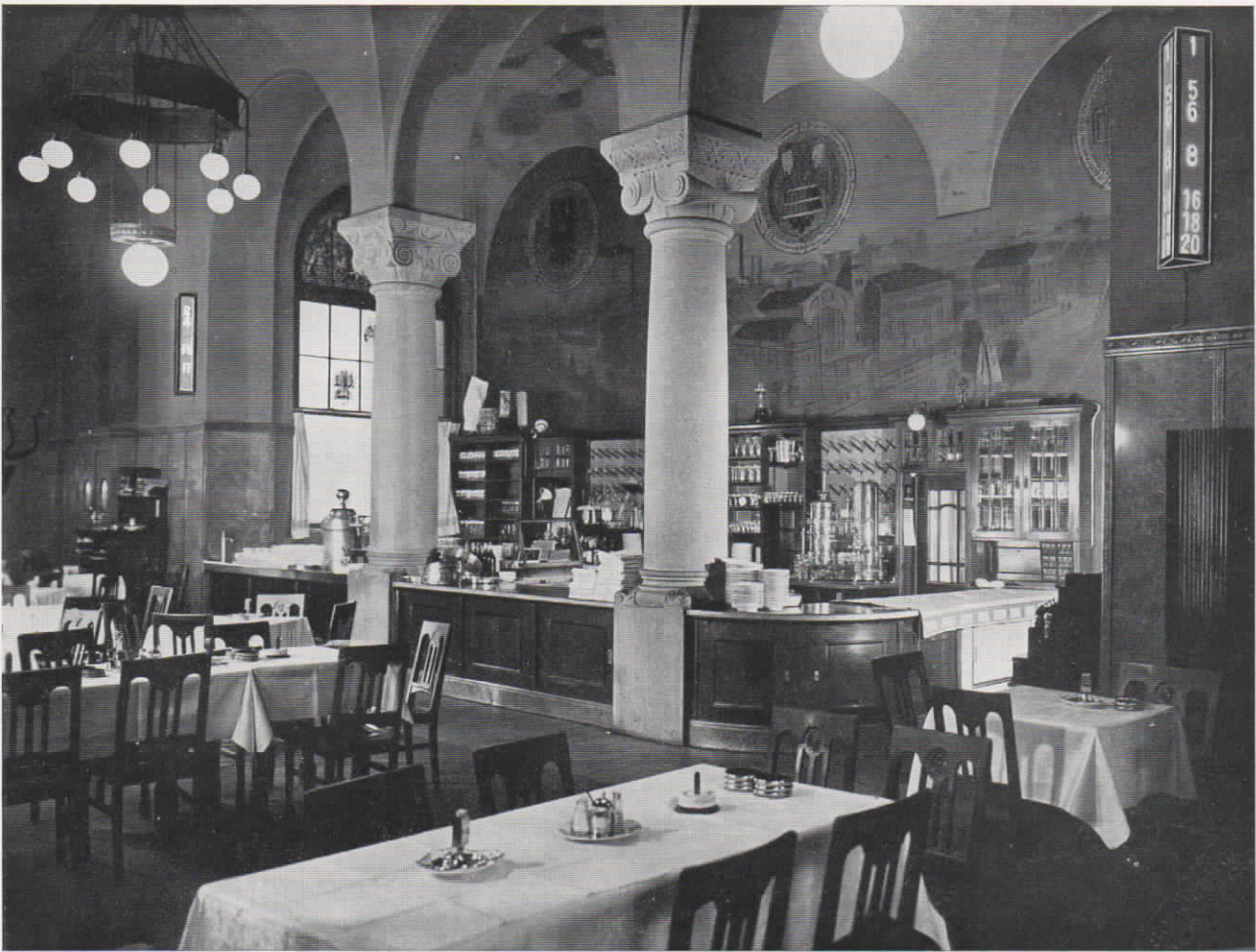
Abb. 8. Dreiecktablo der Lichtsignal-Kellnerrufanlage im Restaurant Nordstern der Unionbrauerei A.-G. in Dortmund
