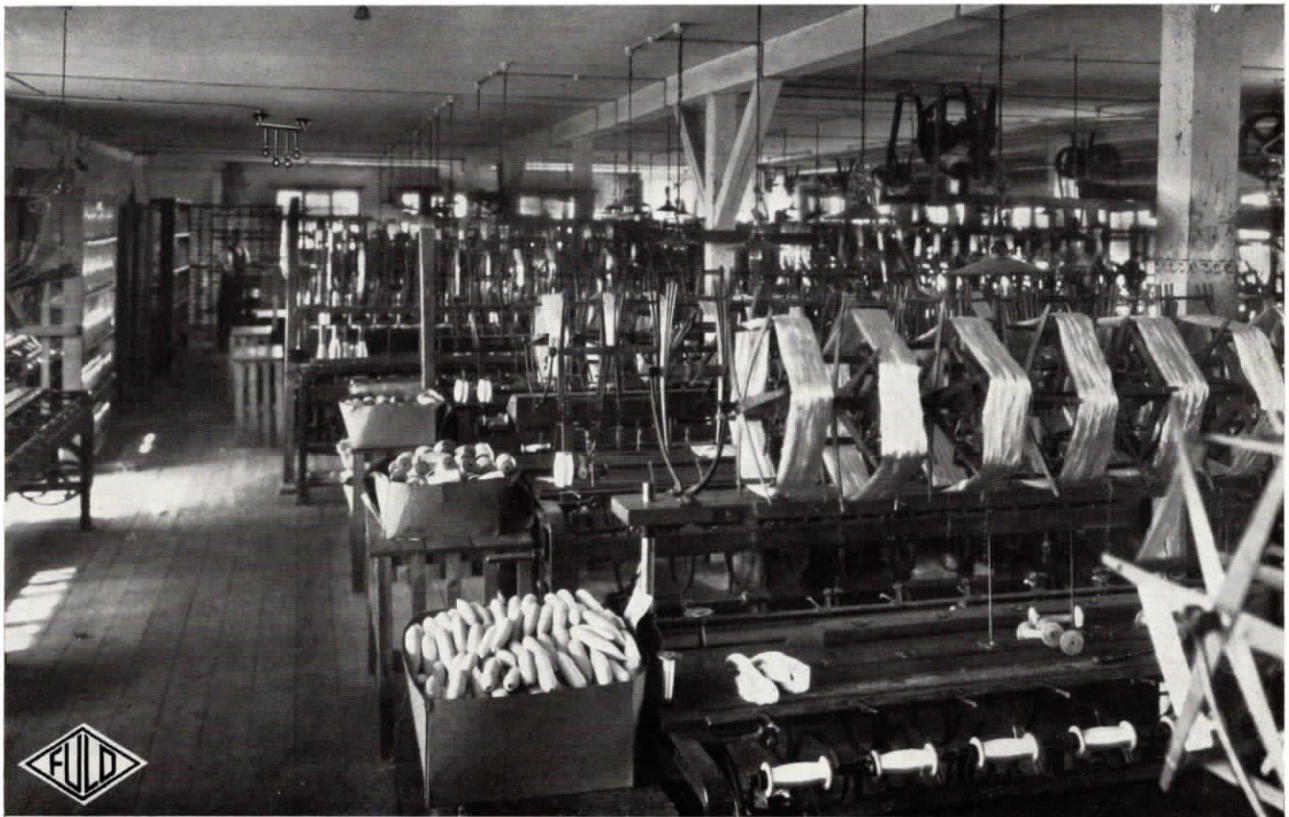
Abb. 32. Spulerei und Schererei mit Fuld-Lichttrufereinrichtung in der C. Hugo Eidner & Co. A.G. Handschuh-, Strumpf- und Wirkwarenfabriken in Göppersdorf bei Burgstädt i. Sa.
