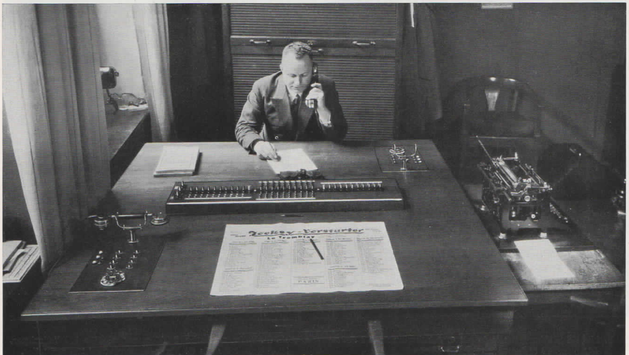
Abb. 28. Fuld-Spezial-Telephontisch mit 2 Arbeitsplätzen, ausgebaut für 3 Amtsleitungen und 10 auswärtige Nebenstellen, mit Börsenschaltung zum gleichzeitigen Rufen und Besprechen aller Nebenstellen zwecks Durchgabe von Rennresultaten in der Wettannahmestelle F. Uffemann Wwe. in Bremen.
