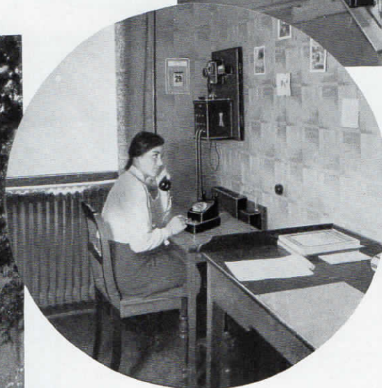
Abb. 84 (links). Abfrageapparat der Fuld-Fernsprechanlage im Kreis Ausschuss Nienburg a. W. Die Fernsprechanlage besteht aus einem manuellen Zentralumschalter, 11 Fernsprechapparaten über 2 Amtsleitungen, 2 Außenstellen und einer vollautomatischen Hauszentrale für 25 Teilnehmer.
