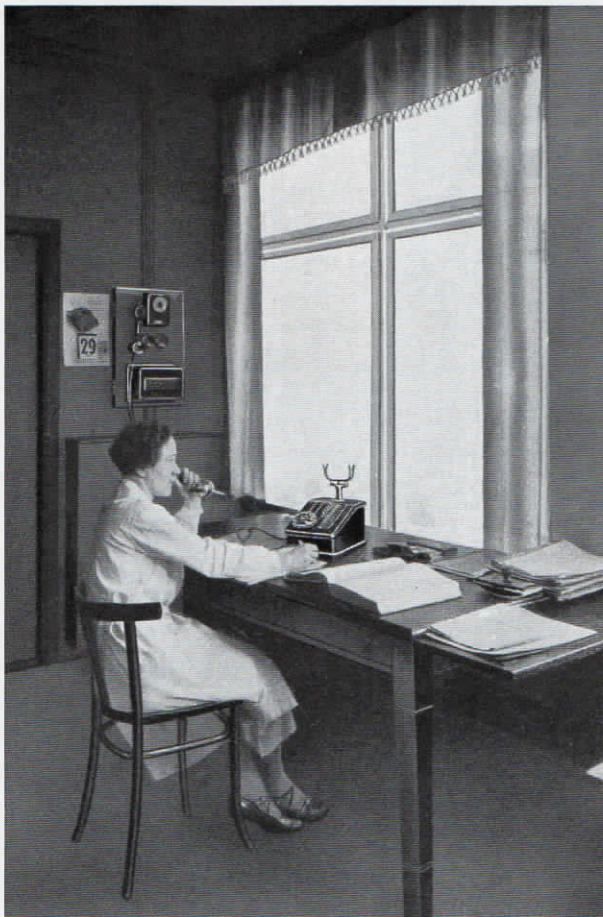
Abb. 69. Bedienungsapparat zur Fuld-Universalzentrale für 2 Amtsleitungen und 20 Nebenstellen im Arbeitsamt in Celle.
