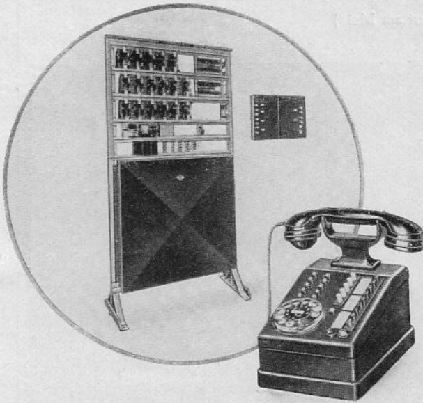
Bild 30 Universalzentrale mit Bedienungsapparat (Baustufe II E)
