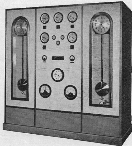
Bild 3 Uhrenzentrale (Rheinmetall Borsig-Werke)
