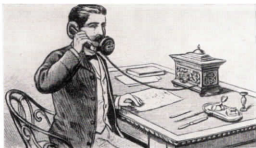
Abb. 121 Eleganter Tischapparat um 1885 Man beachte das große Mikrofon
