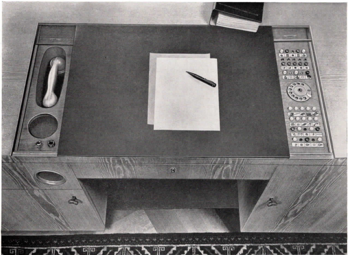
Bild 12 Schreibtischplatte von oben gesehen. Fernsprecheinrichtung mit eingelassenem Handapparat und Lautsprecher zur wechselseitigen Benutzung. Rechts die eingelassenen Tasten für die Fernsprech- und Signaleinrichtungen.
