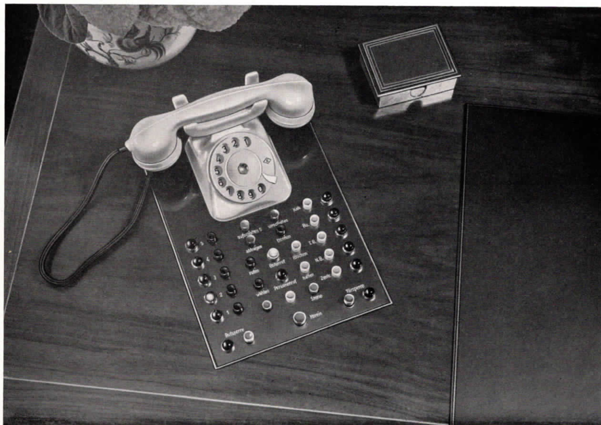
Bild 3 Teil der Schreibtischplatte mit der eingelassenen Fernsprech- und Signaleinrichtung. Die Tastaturplatte ist der bequemeren Handhabung halber schräg in die Tischplatte eingebaut.
