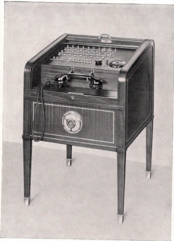
Bild 13 und 14 Fernsprechtisch „Pufu“ mit eingebautem Lautsprecher wie sie in der Rhein-Main-Bank in Frankfurt am Main zur Aufstellung gelangten.
