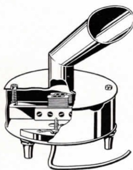
Abb. 120 Mikrophon System Böttcher (1882)
