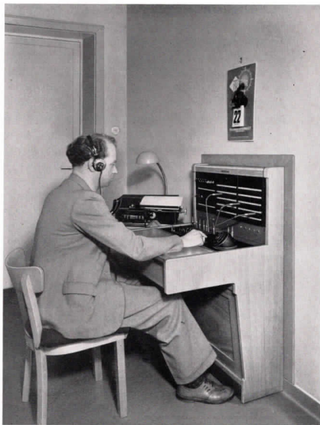
Abb. 1 Schnurzentrale für Blindenbedienung in einem Landratsamt
