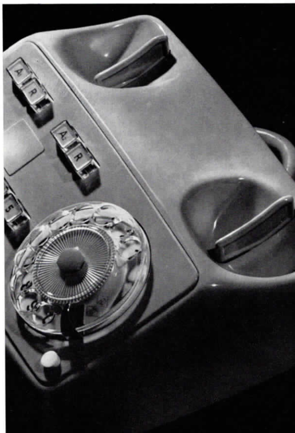
Bild 5 Der in Mulden eingebettete Gabelumschalter
