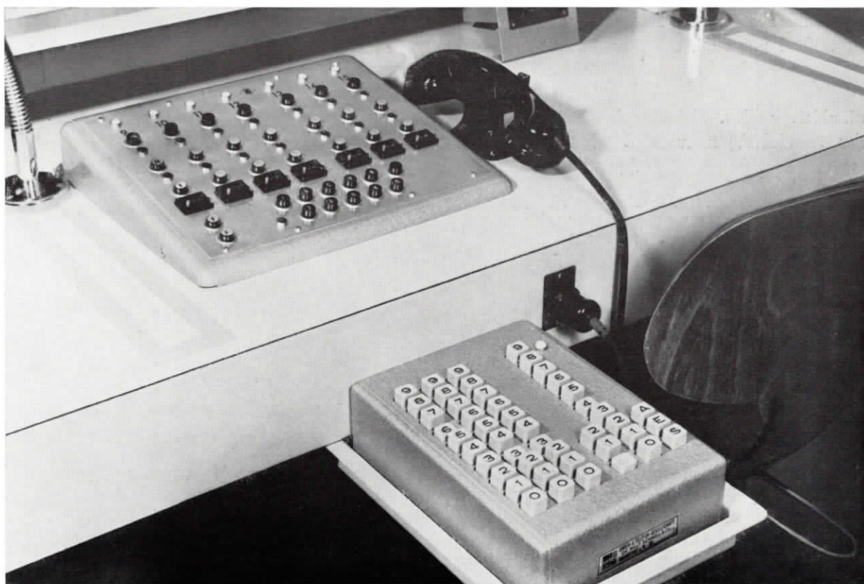
BILD 2 GESAMTANSICHT DES VERMITTLUNGSPLATZES
