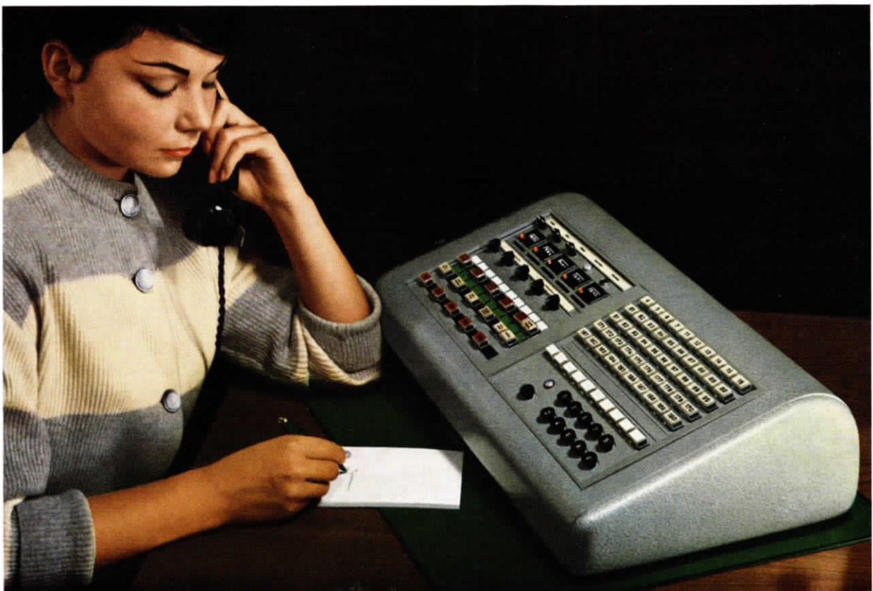
BILD 1 Vermittlungsapparat einer modernen Universalzentrale mit Leuchttastenzuteilung
