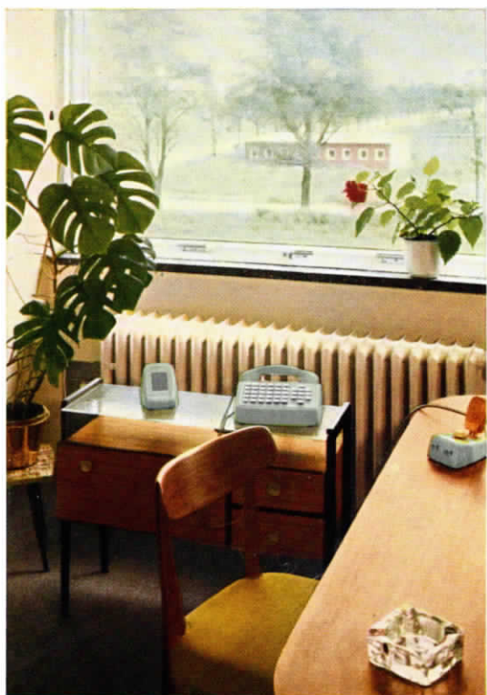
BILD 7 Tastenpult mit Freisprecheinrichtung in einem Direktionszimmer
