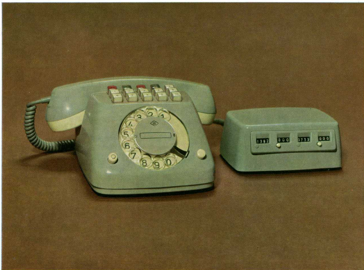
BILD 1 Multireed-Reihenapparat mit 2 Summen- und 2 Rückstellzählern
