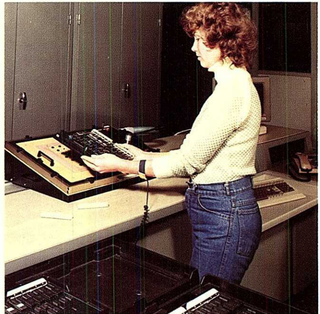
5 In-circuit-Test von EWSD-Baugruppen
