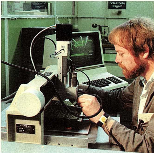
7 CNC-Aufrüstplatz für EWSD-Baugruppen
