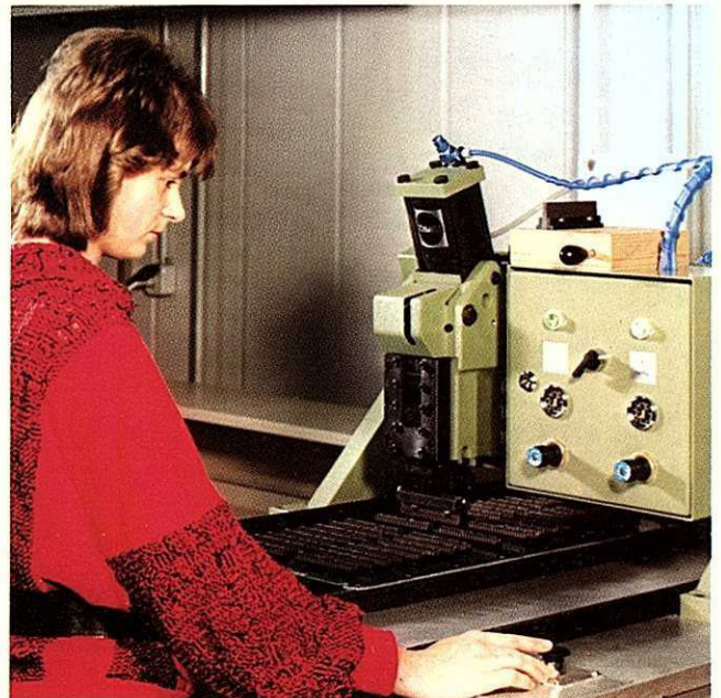
8 Einpressen von Kontaktmessern in Verdrahtungsplatten
