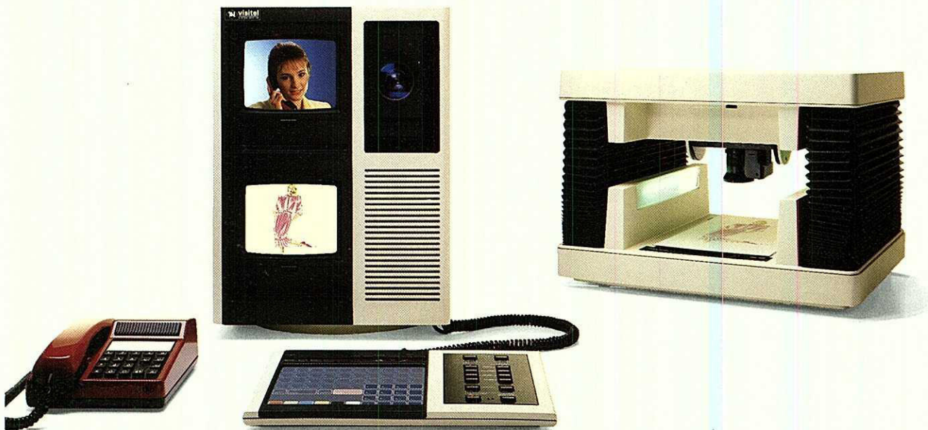
1 Das VISITEL-Terminal, bestehend aus Videoturm, Kamerastation, Bedientableau und Fernsprecher
