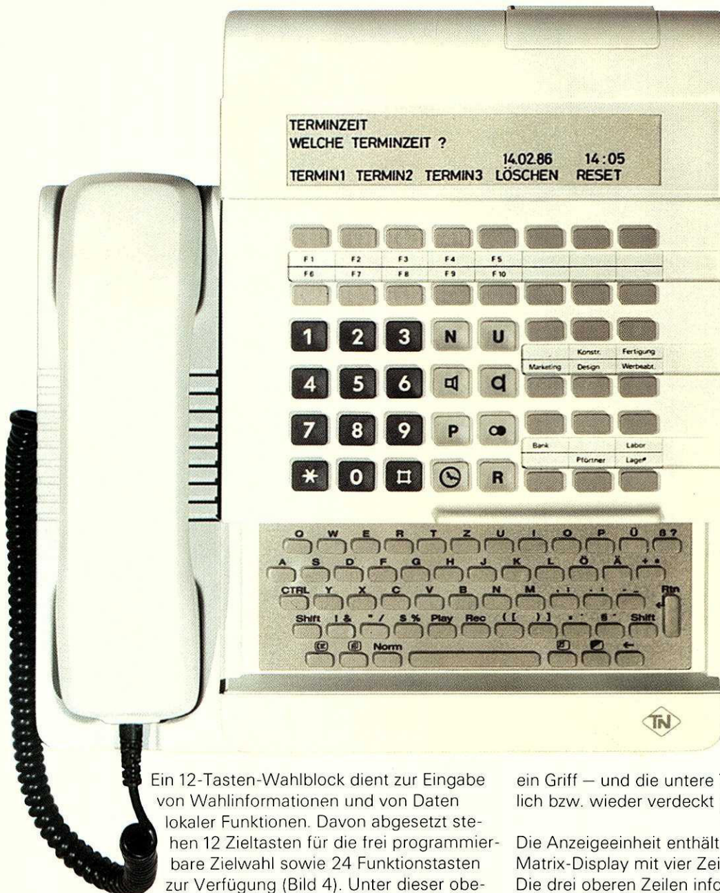
4 Anzeigenfeld und Bedienelemente des TK 93
