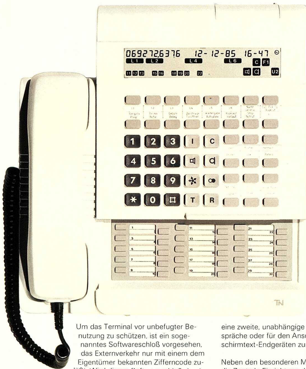
4 Die Benutzeroberfläche des TR-92-Terminals
