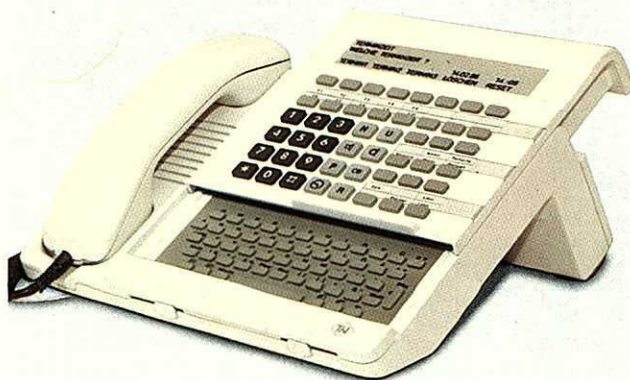
5 Unter der verschiebbaren oberen Tastenanordnung befindet sich die alphanumerische Tastatur
