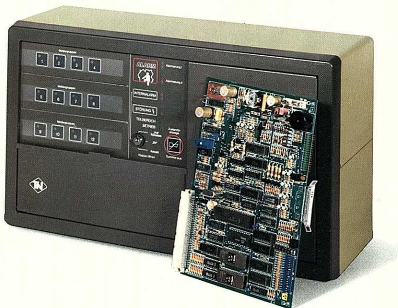
2 Überfall- und Einbruchmelder-Zentrale NZ 1012 mit eingebauter Energieversorgung; davor Leiterplatte aus dem System
