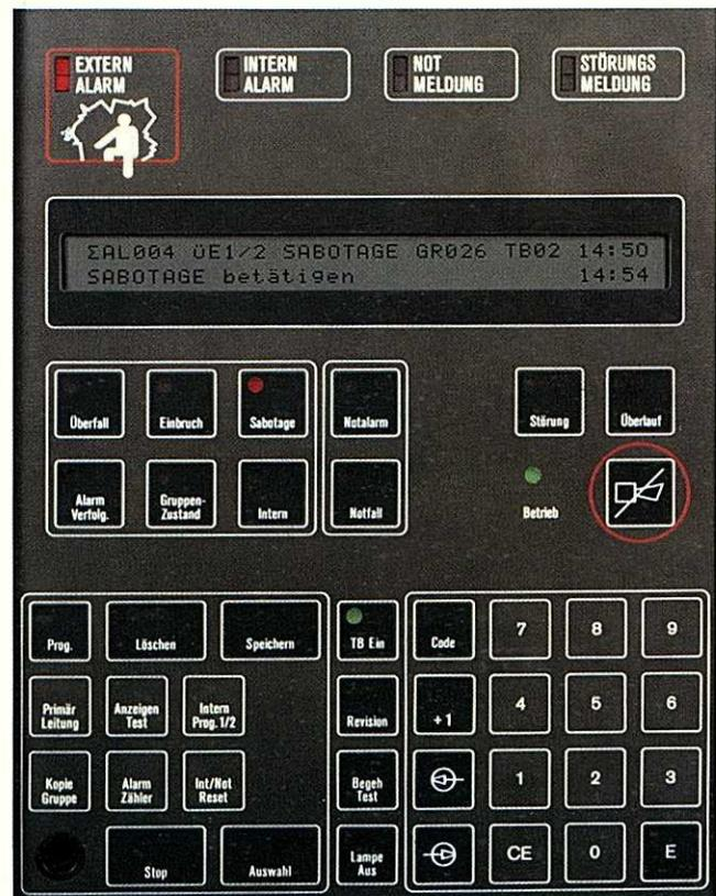
4 Konzentrierte Bedien- und Anzeigeeinrichtung einer Überfall- und Einbruchmelder-Zentrale
