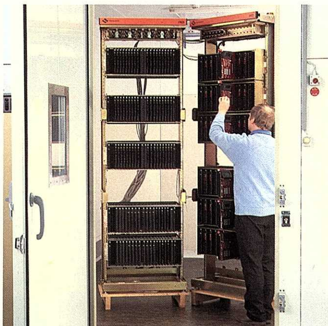
9 Run-in-Kammer mit Prüfling
