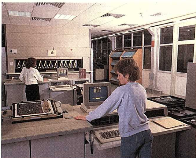
2 Zehntel-Prüfsystem für den In-circuit- und Kombi-Test
