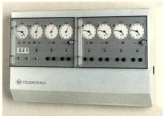
Verteiler-, Meß- und Nachstelleinrichtung VMNE für zentral gesteuerte Zeitdienstsysteme mit vier Minuten- und zwei Sekundenlinien
