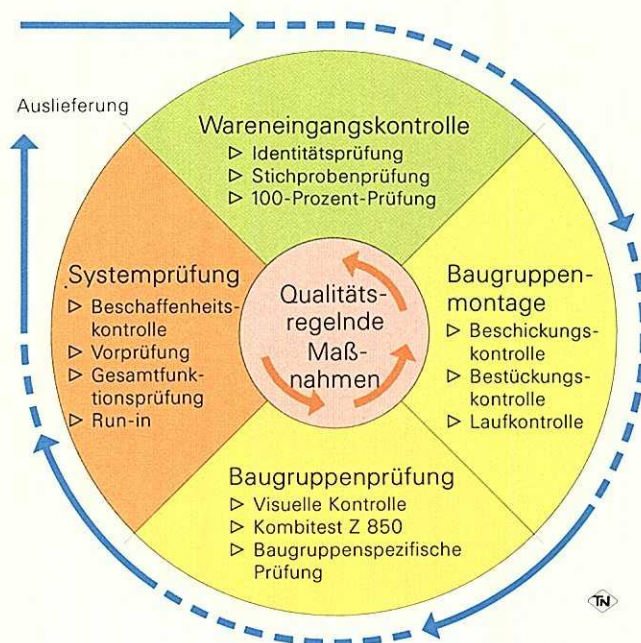
1 Regelkreis der Qualitätssicherung in der EWSD-Fertigung
