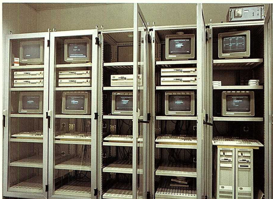
5 PC-Netzwerk für die Steuerung der Anzeigetafeln
