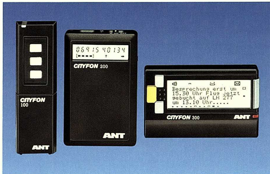
1 Cityruf-Empfänger der verschiedenen Rufklassen, von links: Nur-Ton-Ruf, Numerik, Alphanumerik (Foto: ANT)
