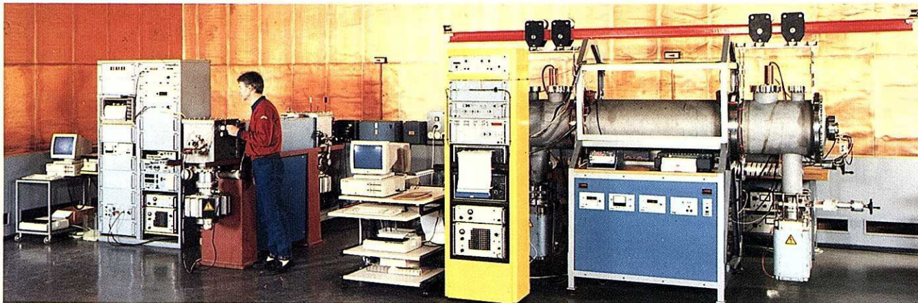
1 Die primären Atomuhren CS1 und CS2 der PTB in Braunschweig stehen in einer abgeschirmten und klimatisierten „Atomuhrenhalle“.
