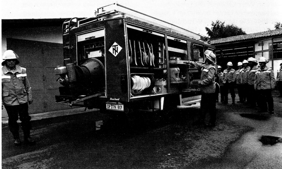
Löschgruppenfahrzeug LF 8 mit ausgefahrenem Leichtschaumgenerator
